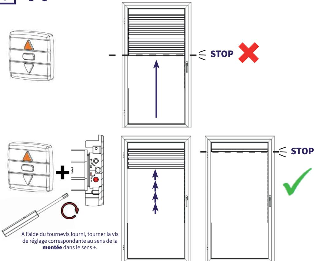
A l'aide du tournevis fourni, tourner la vis de réglage correspondante au sens de la **montée** dans le sens +.
