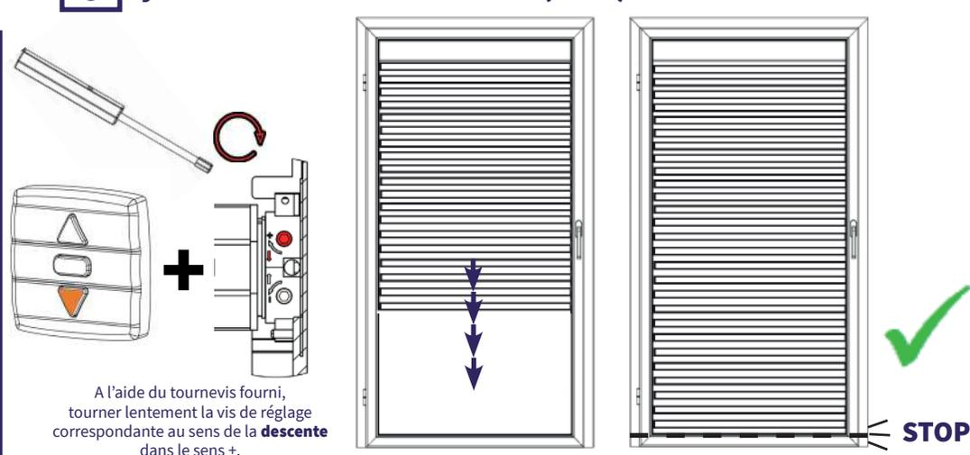
A l'aide du tournevis fourni, tourner lentement la vis de réglage correspondante au sens de la **descente** dans le sens +.
