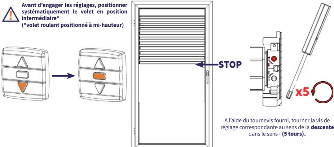
A l'aide du tournevis fourni, tourner la vis de réglage correspondante au sens de la **descente** dans le sens - (**5 tours**).
