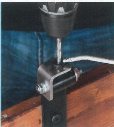
**9** Avec un foret en acier  $\varnothing$  6,5, percez l'œil de chaque penture à 20 mm du bord inférieur. Utilisez de l'huile de coupe et un gabarit pour faciliter le perçage.
