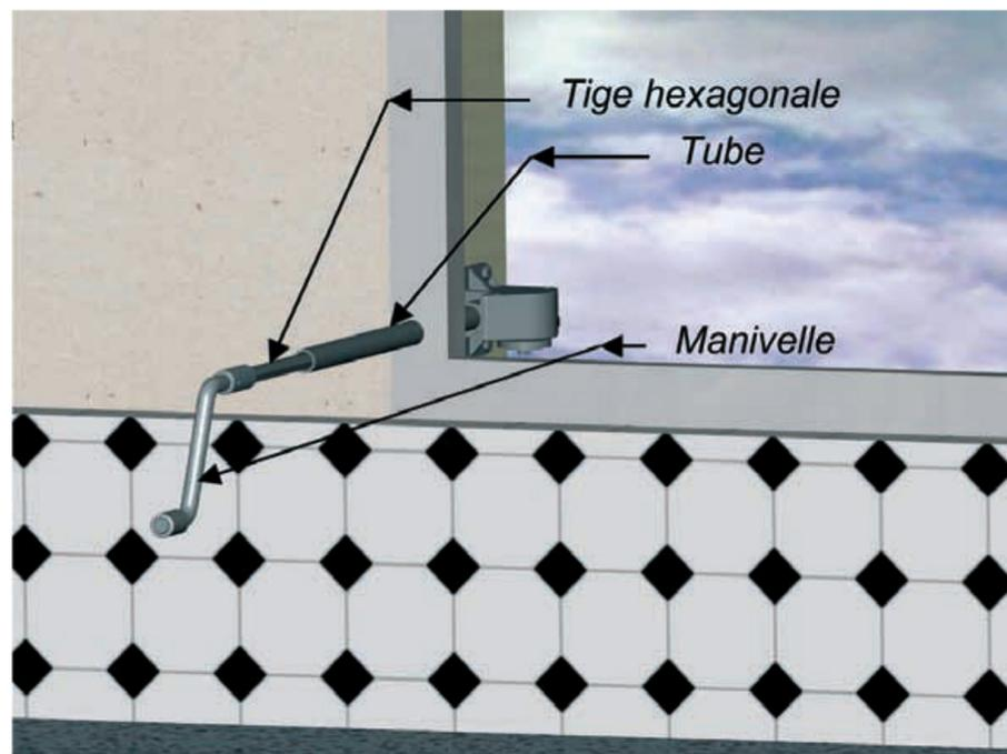
L'alignement entre le TUBE et la tige HEXAGONALE est IMPÉRATIF pour un bon fonctionnement du «WiMan».
