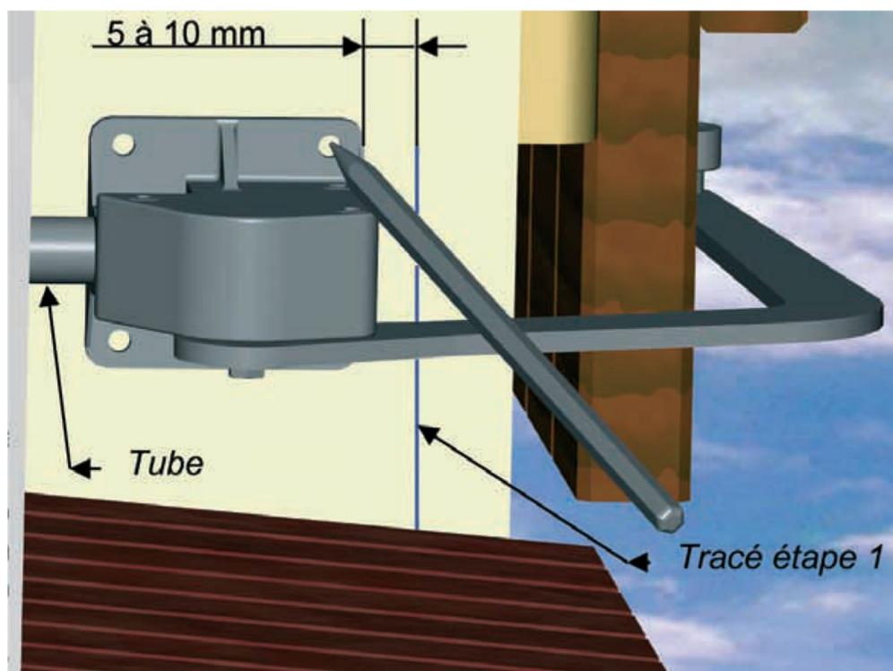
Emmancher le « WiMan » dans le trou puis le positionner de 5 à 10 mm en retrait suivant le tracé de l'étape 1.
