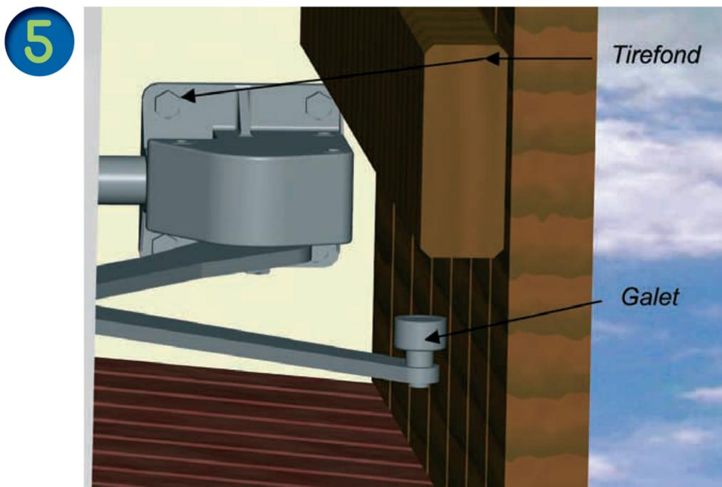
Replacer l'appareil, le fixer avec les tirefonds livrés à cet effet, en vérifiant que la manivelle avec la tige hexagonale s'engage librement dans le tube.
