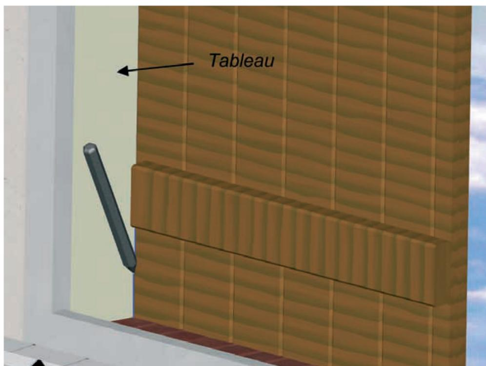
Fermer le volet, puis tracer sur le tableau l'épaisseur du volet.
